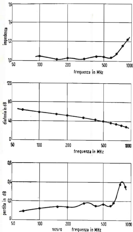
Fig. 3 - Caratteristiche del relè coassiale da 50  $\Omega$  con doppio contatto di scambio. Il disadattamento dovuto ai connettori è risultato trascurabile al disotto di 1000 MHz.
