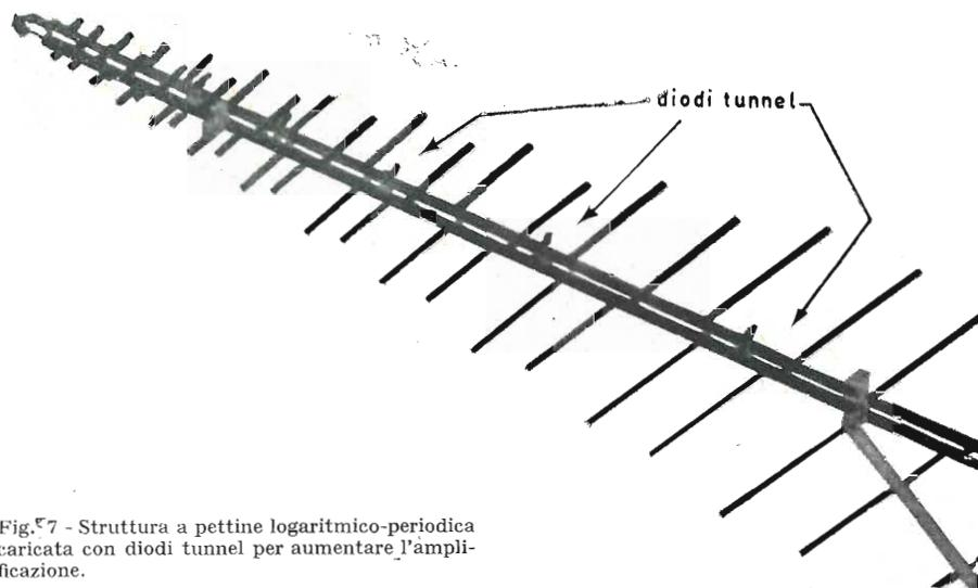
Fig. 7 - Struttura a pettine logaritmico-periodica caricata con diodi tunnel per aumentare l'amplificazione.
