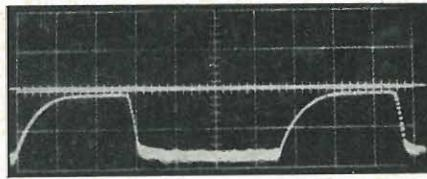
Fig. 3b - Tensione sul condensatore C<sub>2</sub> (500 mV per quadretto).
