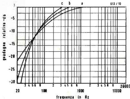
Fig. 6 - Effetto sull'amplificatore dell'impiego di una a), due b) e tre c) sezioni di filtro antirombo rappresentate in fig. 5. Tutte le curve sono sotto 12 dB a 60 Hz.
