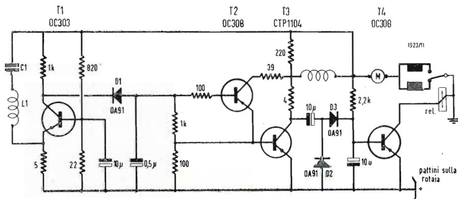
Fig. 2 - Circuito di ricezione montato sul treno.
