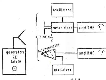
Fig. 3 - Sistema di misura per un antennaverter.
