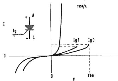
Fig. 2 - Se la tensione applicata a un thyatron al silicio viene elevata, quando l'anodo è positivo, oltre un certo valore  $V_{bo}$ , la caduta di tensione anodo-catodo raggiunge un valore confrontabile con quello dato da un diodo nel senso di conduzione.
