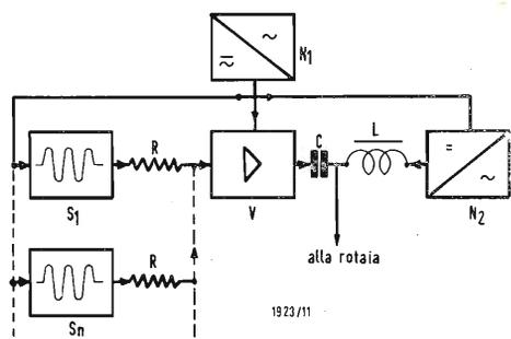
Fig. 5 - Schema a blocchi dell'alimentazione di trazione e dei generatori dei segnali di telecomando.
