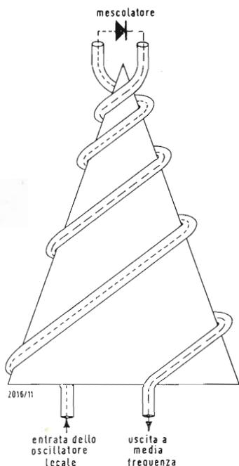
Fig. 1 - Antenavertter (antenna + convertitore) a spirale conica con mescolatore integrato nell'antenna.
