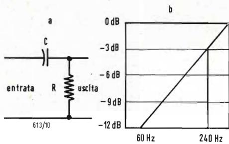
Fig. 5 - a) è il circuito di un filtro antirombo e b) è la risposta dell'amplificatore col filtro.
