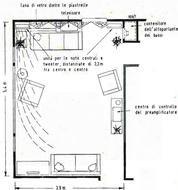
Fig. 4 - Pianta della stanza di audizione.
