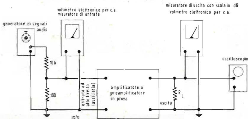
Fig. 1 - Apparecchiatura di prova.  $R_L$  è uguale alla resistenza di carico caratteristica al trasformatore di uscita dell'amplificatore di potenza. Non usare questa resistenza quando si prova un preamplificatore.
