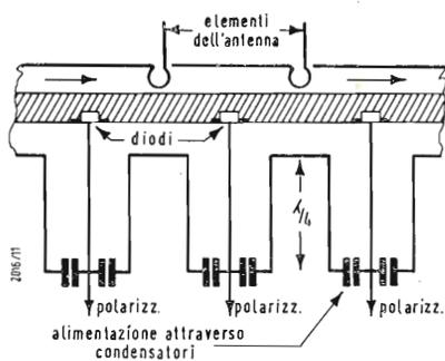
Fig. 6 - Antennafier a pettine con diodi tunnel.
