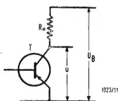
Fig. 1 - Disposizione circuitale per il calcolo delle potenze sul transistor di commutazione.
