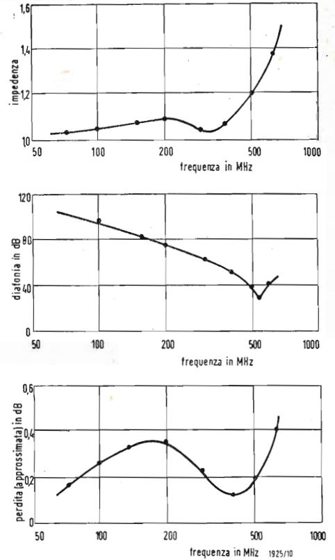
Fig. 10 - Caratteristiche del relè da 75  $\Omega$  a doppio scambio in associazione con il relè a semplice scambio chiuso sulla linea.
