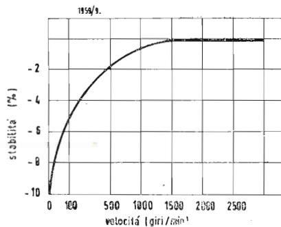
Fig. 6 - Curva della stabilità « assoluta » di velocità ottenuta con un variatore di 2 CV e una dinamo tachimetrica calettata sull'albero del motore per un carico variabile dal 25 al 100%.
