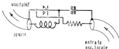
Fig. 2 - Circuito equivalente alla struttura della fig. 1.
