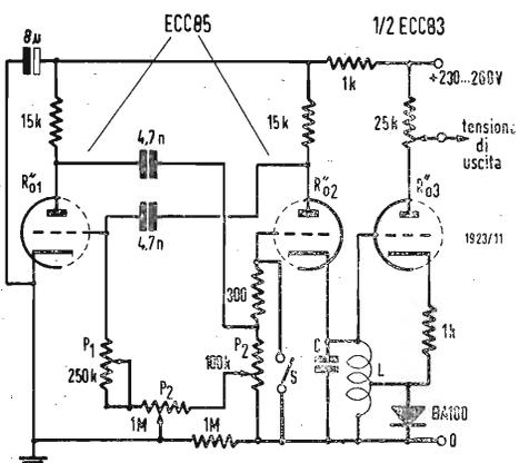
Fig. 6 - Disposizione circuitale del generatore dei segnali di telecomando.
